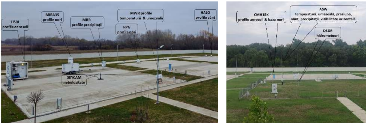
Fig.1. Instrumentele de teledetecție disponibile pentru sezonul convectiv 2023 pe platformele de la MARS
